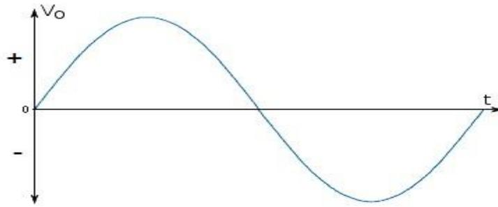
Figura Tensión alterna del tipo sinusoidal.
